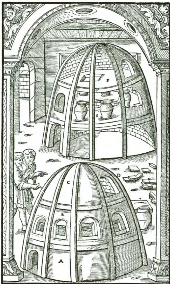
„Ülový typ“ pece z knihy nemeckého učenca a mineralóga G. Agricola 5
