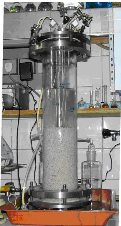
Obr. 1: Náplňový bioreaktor se siranovými kuličky a válečky.
