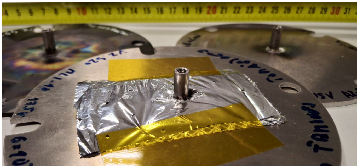
Vzorka s privareným svorníkom cez ochrannú MLI vrstvu. Zdroj ÚMMS SAV, v. v. i.
