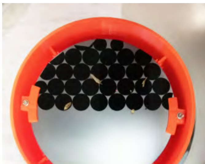
Vľavo kremíkový substrát spoločne pokrytý grafitovými lepiacimi páskami so zachytenými časticami, flórou a faunou z kukurice a vpravo častica pod mikroskopom, potencionálny mikrometeorit
