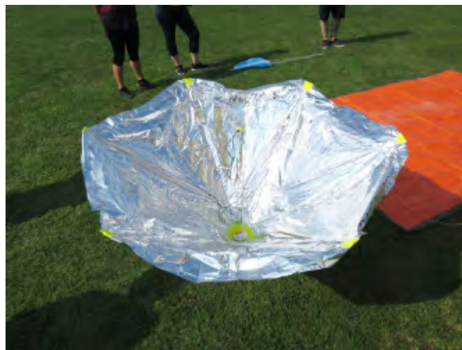
Vľavo lapač mikrometeoritických častíc (oranžovej farby s duralovými rúrkami), v strede hlavný inžinier A. Buček, vľavo už s napnutou fóliou ako aerodynamickým lievikom pre vstup mikročastíc do lapača
