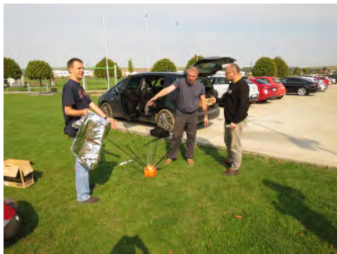
Vľavo lapač mikrometeoritických častíc (oranžovej farby s duralovými rúrkami), v strede hlavný inžinier A. Buček, vľavo už s napnutou fóliou ako aerodynamickým lievikom pre vstup mikročastíc do lapača
